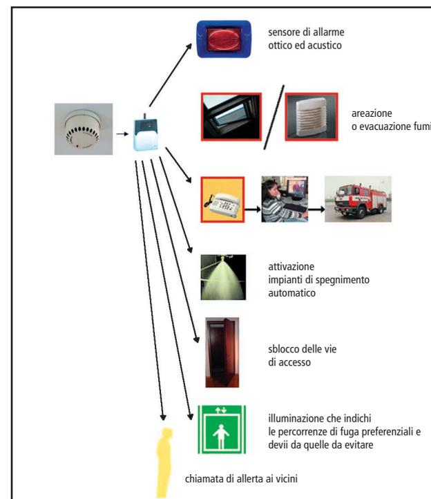
schema di funzioni che un sistema di rilevazione antincendio automatico può gestire
